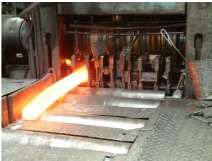
Válcování čtvercové tyče za tepla
