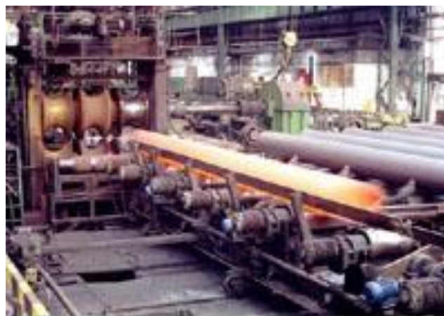
Válcování trubek za tepla a kalibrace
